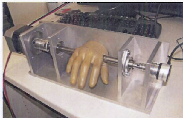
Una simulazione in laboratorio per studiare i movimenti della mano e del braccio teleguidati
