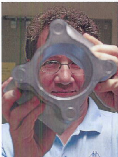
Il professor Franco Bonollo mostra un cilindro per motore di auto che ha realizzato in una lega leggera. FRANCESCO DALLA POZZA
